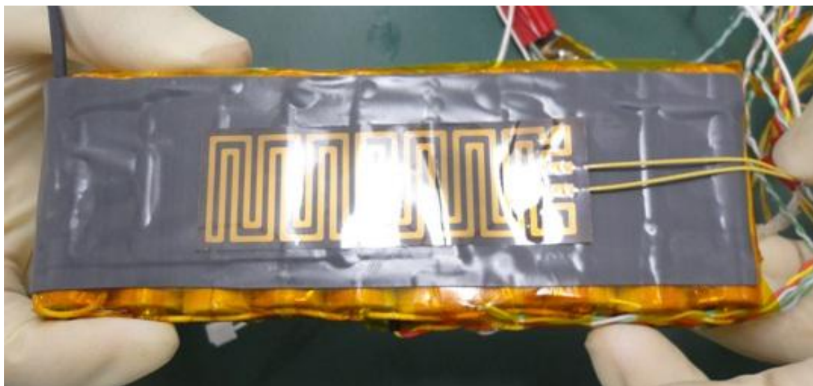
図 3.1-10 シートヒータの設置
