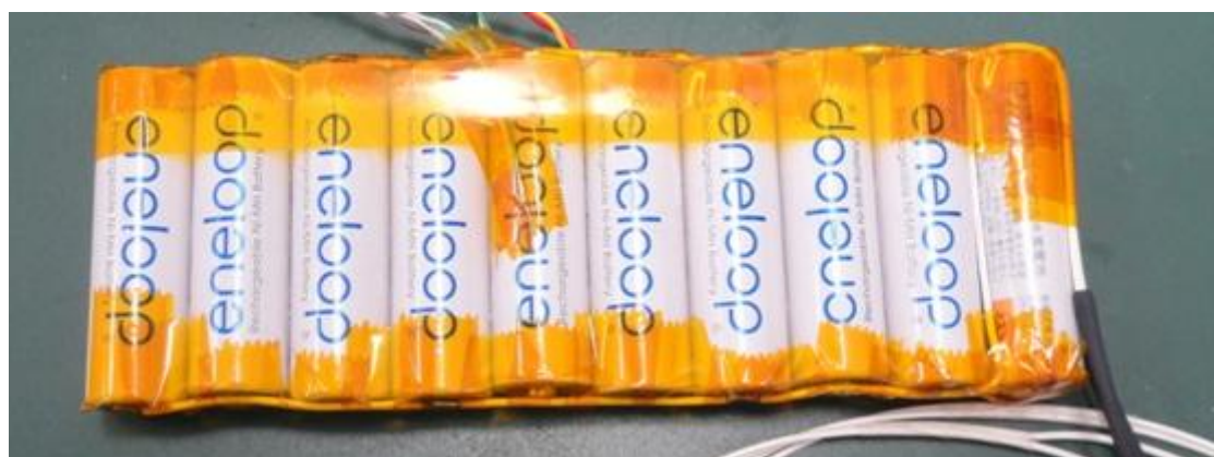
図 3.1-6 熱電対の配置 (パック裏面) Fig. 3.1-6 Layout of temperature sensor (bottom)
