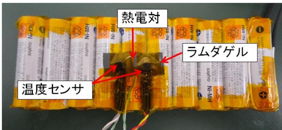
図 3.1-5 温度センサ、熱電対の配置 (パック表面) Fig. 3.1-5 Layout of temperature sensor and thermocouple (top)
