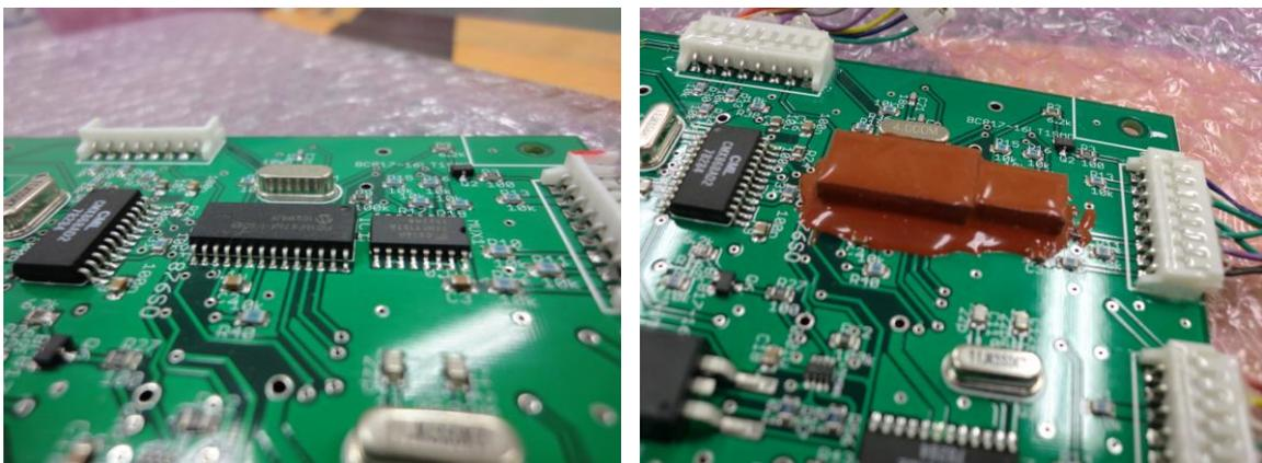
図 2.10 左：タングステン装着前 右：タングステン装着後（通信基板）
